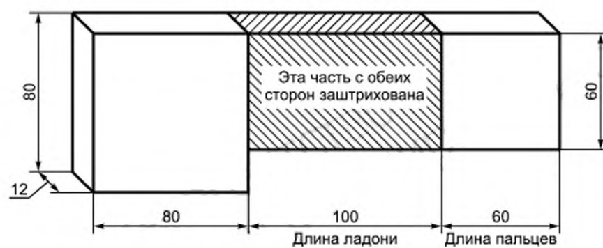
Рисунок Н.1 — Устройство для испытания захватываемой детали
