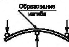
Рисунок 18 — Пример образовавшегося изгиба у образца
