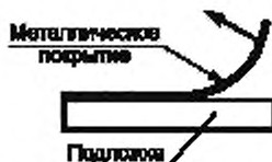
Рисунок 1 — Пример получения свободного покрытия
