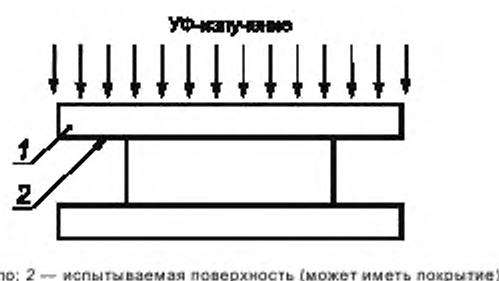
Рисунок 4 — Расположение поверхностей стекла, испытываемых УФ-облучением
