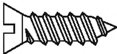
Рисунок 1 — Самонарезающий формирующий винт
