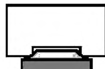
Рисунок А.40 — Совмещение: допустимое состояние
