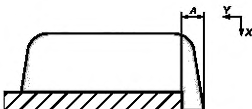
Рисунок 2 — Контур и сечение паяльной пасты: допустимое состояние
