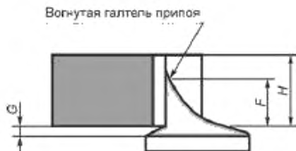
Рисунок А.25 — Галтель припоя: заданное состояние
