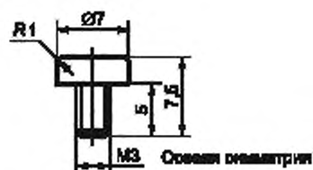
Верхняя часть центрального проводника. Нормализованная сталь. Приблизительно 2:1
