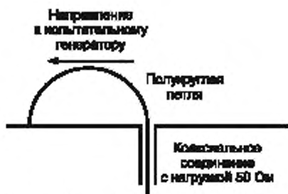
Рисунок D.3 — Полукруглая петля на пластине заземления
