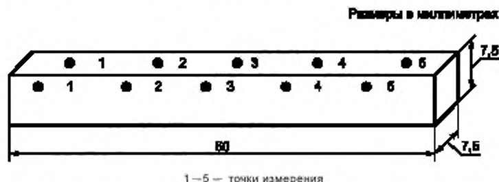
Рисунок 4 — Возможная форма и размер пластины для исследования однородности распределения СФФ и изготовления СО СФФ
