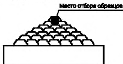
Рисунок 5 — Схема выполнения семислойной наплавки покрытыми электродами и проволокой
