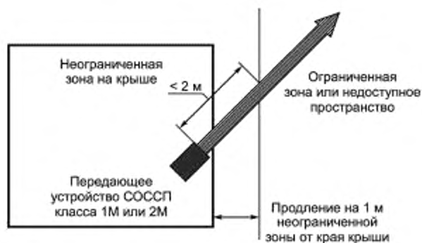
Рисунок 4 — Передающее устройство лазеров класса 1М или 2М вблизи края крыши в неограниченной зоне
