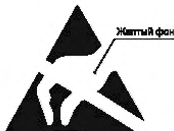
Рисунок 12 — Чувствительная к электростатическому разряду деталь или узел
