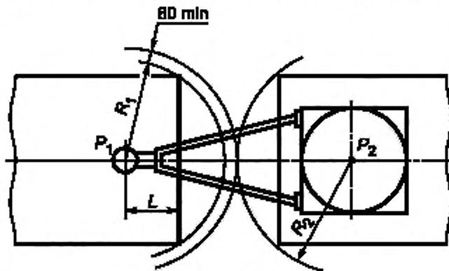
$R_1$  — радиус габарита задней части тягача (прицепа или полуприцепа для многозвенного автопоезда);  $R_2$  — радиус габарита передней части прицепа;  $P_1$  — центр тягово-цепного устройства;  $P_2$  — центр поворотного устройства прицепа;  $L$  — расстояние до центра тягово-цепного устройства (для прицепов с центральной осью (осями) — не более 420 мм)
