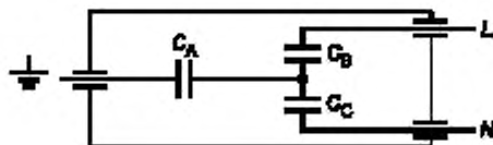
Рисунок 5с — Шунтирующий конденсатор, соединенный по схеме в форме буквы Т
