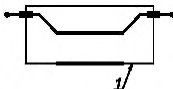
Рисунок 4б — Проходной конденсатор для несимметричного включения в цепь (некоаксиальный)
