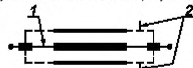
1 — центральный токоведущий проводник; 2 — круглый монтажный заземленный фланец
