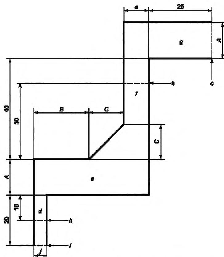
А — расстояние, в 1,1 раза превышающее диаметр окружности поворота по следу колес, или 14 м (в зависимости от того, какой из размеров больше); В — расстояние, в 1,75 раза превышающее диаметр окружности поворота по следу колес, или 22 м (в зависимости от того, какой из размеров больше); С — расстояние, в два раза превышающее максимальную колесную базу, или 15 м (в зависимости от того, какой из размеров меньше)
