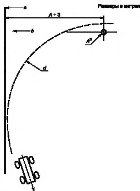
А — расстояние, в 1,1 раза превышающее диаметр окружности поворота по следу колес, или 14 м в зависимости от того, какой из размеров больше; а — перпендикуляр к первоначальному направлению движения; б — первоначальное направление движения; с — положение передней оси в момент начала управляемого движения (см. 10.3.8); д — внешняя линия следа колес
