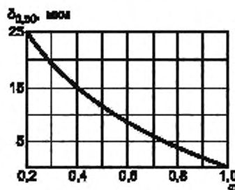
Рисунок А.2 — Зависимость средней тонкости отсева \delta_{0,50} от коэффициента отсева \varphi фильтра (фильтрующего элемента)
