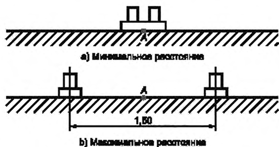
Рисунок В.1 — Установка акселерометров при определении f_2
