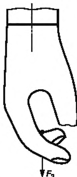
Рисунок 4 — Схема испытания фиксатора пальцев
