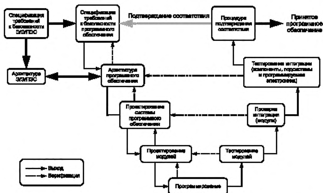
Рисунок 1 — Жизненный цикл программного обеспечения, связанного с безопасностью (V-модель)
