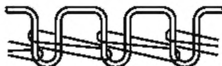
Двойной закрытый шов — шов с двумя нитками
