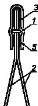
Сшивка с последующей оклейкой лентой; лента поверх шва
