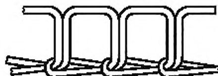
Цепной шов — шов с одной ниткой
