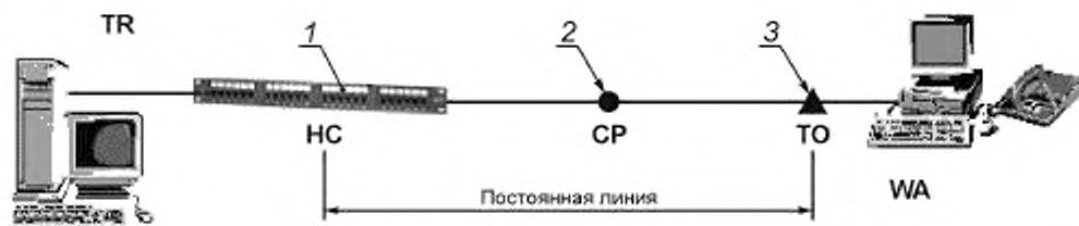
1 — коннектор второй единицы коммутационного оборудования в горизонтальном кроссе (HC); 2 — коннектор консолидационной точки (CP); 3 — коннектор телекоммуникационной или многопользовательской розетки (TO или MuTOA) Рисунок 15 — Модель постоянной линии горизонтальной кабельной подсистемы с тремя точками коммутации
