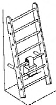
Рисунок 5 — Схема установки или подвески контрольного груза
