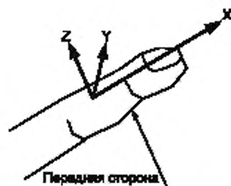
Рисунок 3 — Стандартное положение и система координат объекта биометрии сосудистого русла пальца. Евклидово направление — правостороннее
