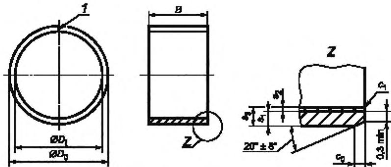
**П р и м е ч а н и е** — Выносной элемент  $Z$  показан для втулки, изготовленной из многослойного материала, где  $s_1$  — толщина стальной основы,  $s_2$  — толщина слоя антифрикционного материала как основа для расчета в соответствии с ИСО 3547-2;  $s_3$  — полная толщина стенки;  $c_0$  и  $c_1$  — наружная и внутренняя фаски;  $c_1$  — может быть радиусом или фаской.
