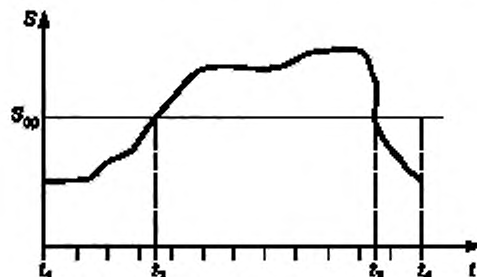
Рисунок А.1 — Пример типового суточного графика нагрузки центра питания
