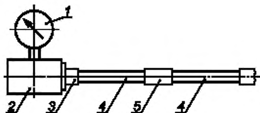
1 — манометр для измерения давления; 2 — нагнетательный насос; 3 — соединение насоса; 4 — труба; 5 — испытуемый фитинг
