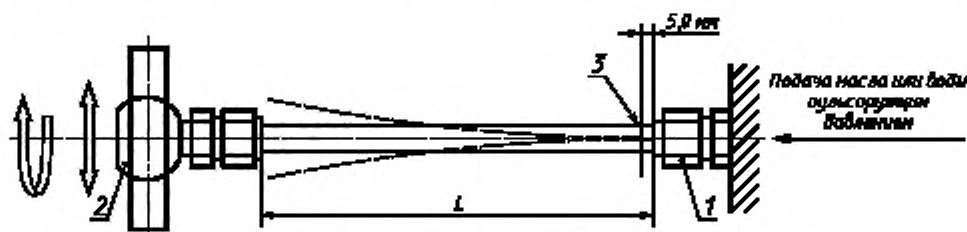
1 — испытуемый образец; 2 — движущийся конец; 3 — место установки тензодатчика
