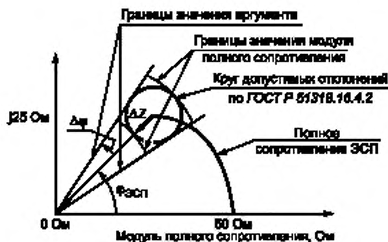
Рисунок К.1 — Определение допустимых отклонений значения модуля полного сопротивления и аргумента
