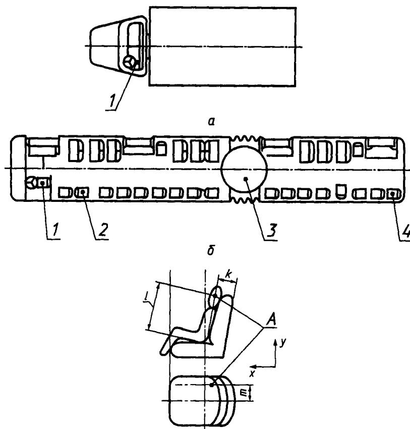
1, 2, 3, 4 — точки отбора проб; A — расположение пробоотборного устройства и точек измерения; координаты точек отбора проб, мм:  $k = 200 \pm 50$ ;  $l = 700 \pm 50$ ;  $m = 300 \pm 50$
