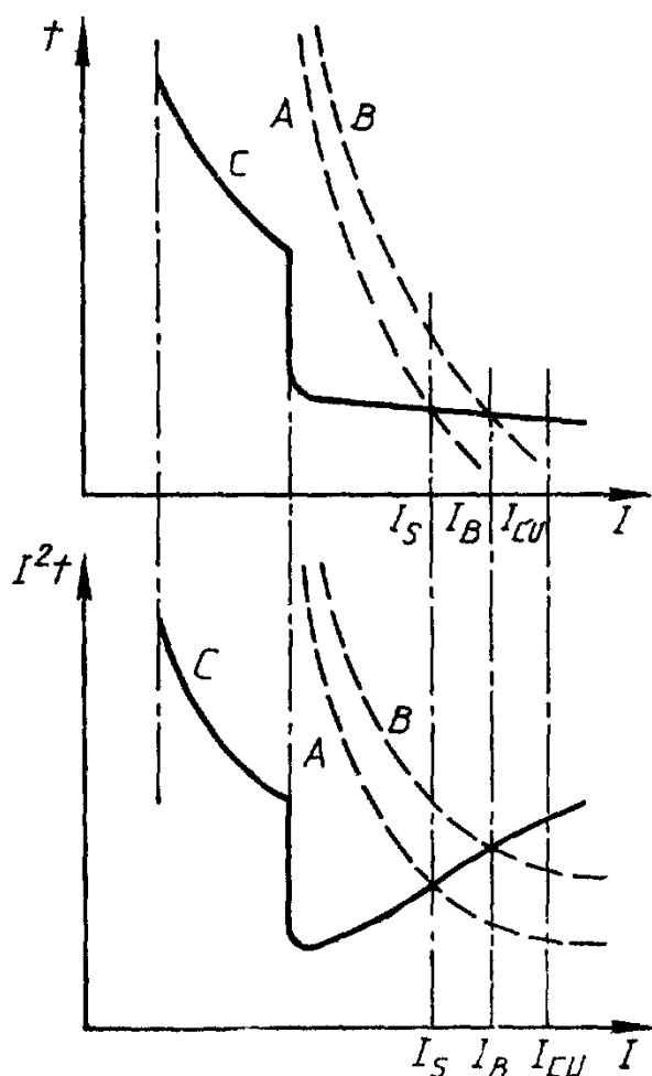
$I$  — ожидаемый ток короткого замыкания;  $I_{cu}$  — номинальная предельная наибольшая отключающая способность (4.3 5.2.1);  $I_s$  — предельный ток селективности (2.17.4);  $I_B$  — ток координации (2.17.6); **A** — преддуговая характеристика плавкого предохранителя; **B** — рабочая характеристика автоматического выключателя (время отключения/ток и  $I^2t$ /ток)
