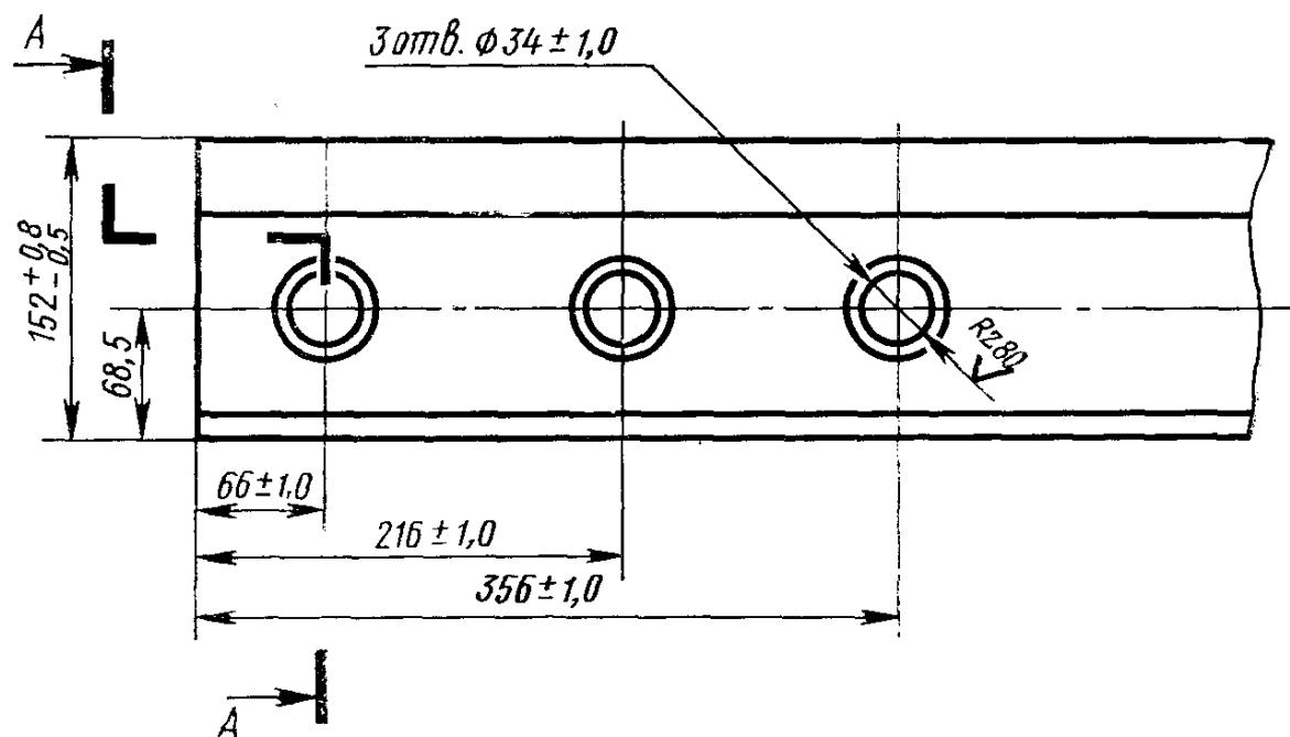
Приложение. Расположение болтовых отверстий контролируется по клиновой части пазухи.
