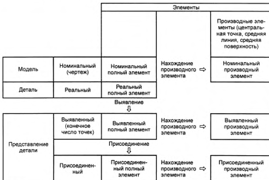
Рисунок 2 — Матричная структура определений геометрических элементов
