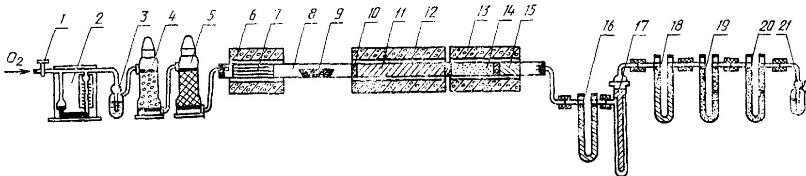
1 — кран для регулировки расхода кислорода; 2 — расходомер; 3, 4, 5 — система очистки кислорода; 6 — печь первая; 7 — рулон из медной сетки; 8 — трубка для сжигания; 9 — лодочка с навеской; 10 — пробка из медной сетки; 11 — оксид меди; 12 — печь вторая; 13 — печь третья; 14 — свинец хромовокислый; 15 — рулон из серебряной сетки; 16, 17, 18, 19, 20 — поглотительная система; 21 — счетчик пузырьков, наполненный концентрированной серной кислотой
