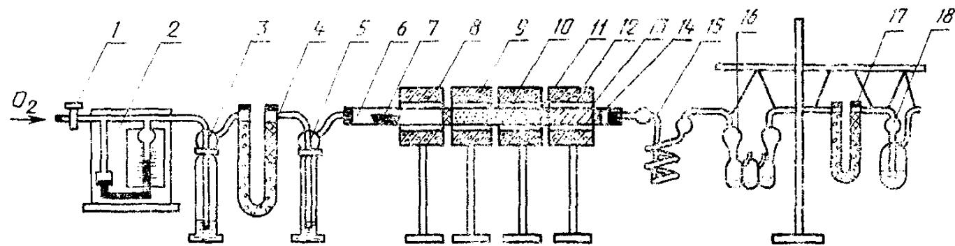
1 — кран тонкой регулировки на линии подачи кислорода; 2 — реометр для измерения скорости тока кислорода; 3, 4, 5 — система очистки кислорода; 6 — трубка для сжигания; 7 — лодочка с навеской; 8, 9, 10, 12 — электропечи типа СУОЛ 0,25.1.1/12МР; 11 — гранулированный оксид меди или оксид хрома; 13 — плавленый хромовокислый свинец; 14 — пробка из медной сетки или из прокаленного волокнистого асбеста; 15, 16, 17 — поглотительная система; 18 — счетчик пузырьков с концентрированной серной кислотой
