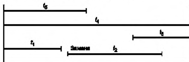
Рисунок 2 — Пример вычисления T_i^* для пяти невосстанавливаемых объектов ( T_i^* = t_1 + t_2 + t_3 + t_4 + t_5 )
