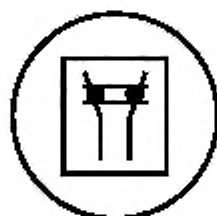
Рисунок L.2 — Символ маркировки аппарата, содержащего механически связанные контакты
