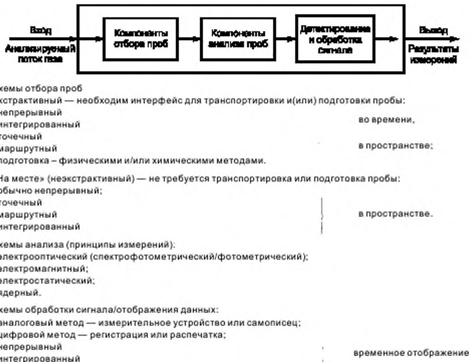
Рисунок D.1 — Варианты измерительной системы
