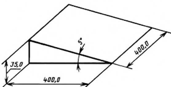
Приспособление представляет собой наклонную плоскость с углом наклона  $5^\circ$ , которое устанавливают на горизонтальной поверхности поверочного стенд или стола. Приспособление может быть изготовлено из любого металла (из алюминия или алюминиевых сплавов). Его собирают из отдельных элементов (пластины и боковых укосин) или отливают в виде полой детали. Наклонную поверхность обрабатывают соответствующим образом для придания ей плоскости.
