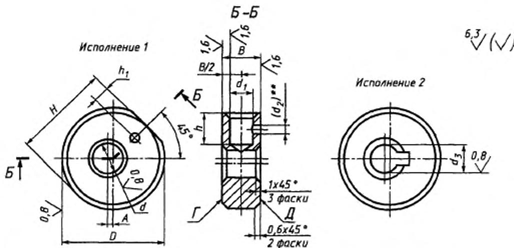
\*\* Размер в скобках — после сборки. Отверстие под штифт развернуть с полем допуска К7.
