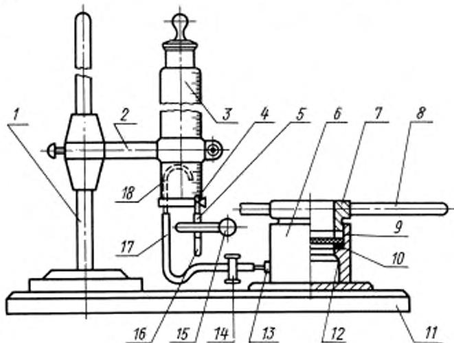
Прибор состоит из пустотелой цилиндрической камеры 6, закрепленной на доске 11, и стеклянного градуированного цилиндра 3 емкостью 250 см<sup>3</sup> с пришлифованной пробкой.
