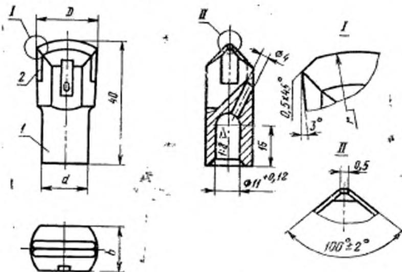
I — корпус коронки, 2 — пластинка твердосплавная по технической документации, утвержденной в установленном порядке.
