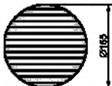
Рисунок 2 — Ударный элемент, моделирующий голову
