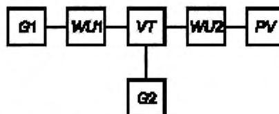
G1 — генератор высокочастотного сигнала; WU1, WU2 — аттенюаторы развязки, VT — контактодержатель с измеряемым транзистором; PV — электронный индикатор напряжения; G2 — блок питания транзистора
