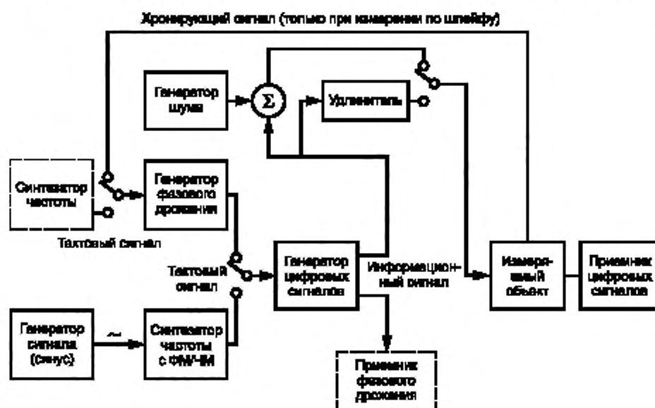
Рисунок 4.8 — Схема измерения фазового дрожания (метод по критерию увеличения K_0 )
