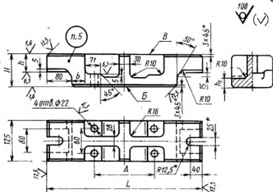
\* Окончательный размер устанавливается по ширине паза ползуна пресса.
