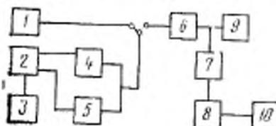
1-источник напряжения переменного тока; 2-потенциометр постоянного тока; 3, 10-образцовые меры э.д.с. (порядковые элементы); 4-эталонный или образцовый преобразователь напряжения; 5-поверяемый прибор; 6-переключатель направления постоянного тока; 7-делитель напряжения постоянного тока; 8-источник напряжения постоянного тока
