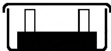
Рисунок В.1 — Коробка со встроенным соединительным устройством
