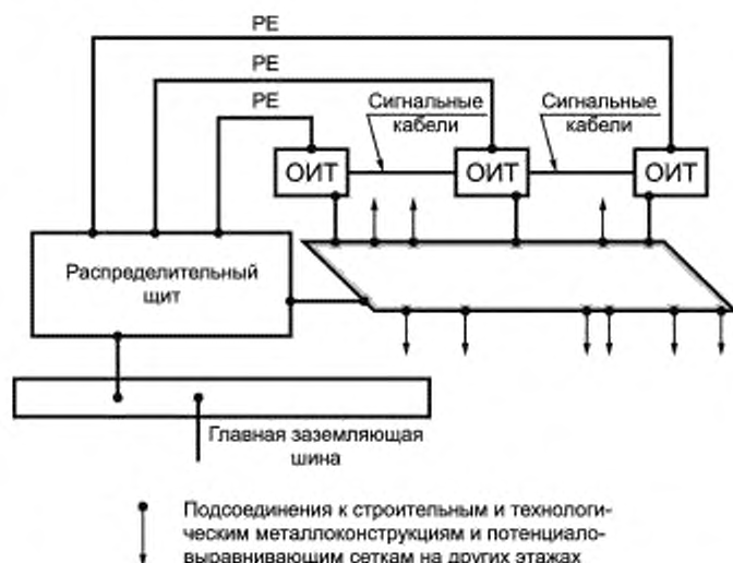
Рисунок В.3 — Система горизонтального и вертикального эквипотенциального заземления
