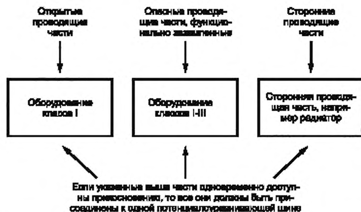
Рисунок 1 — Блок-схема уравнивания электрических потенциалов открытых, опасных и сторонних проводящих частей
