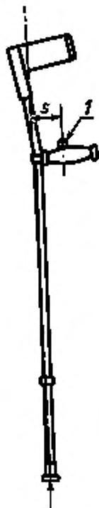
Рисунок 4 — Схема приложения испытательной нагрузки
