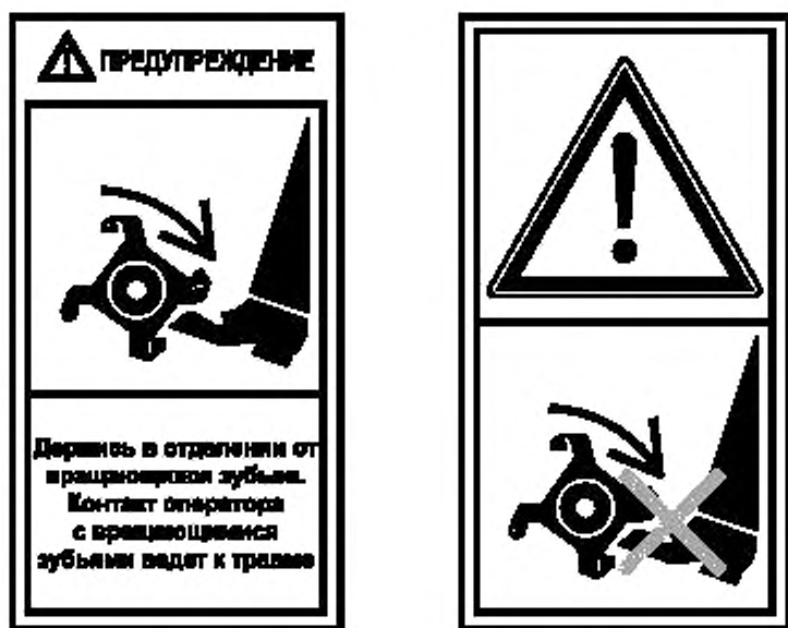
Рисунок 7 — Пример знаков безопасности для предупреждения о риске от контакта с вращающимися зубьями
