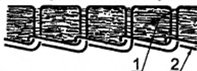
1 — волокистый прочес, 2 — нити цепного стежка (переплетение «цепочка»)
