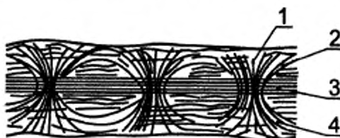
1 — вертикальное соединение; 2, 4 — слой волокон (прочес), 3 — каркас
