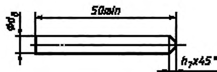
Рисунок 105 — Калибр для проверки фазных гнезд
