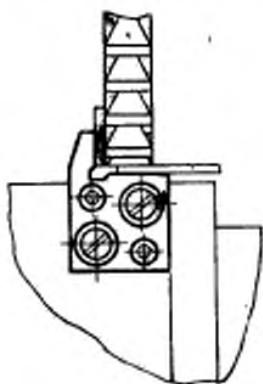
Изменение № 2 ГОСТ 13446—68 Установы угловые торцевые для стационарных приспособлений. Конструкция и размеры
