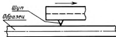
2.2. Контролируемый образец проволоки закрепляется в приспособлении так, чтобы измеряемая поверхность была параллельна плоскости измерения и ходу датчика.
